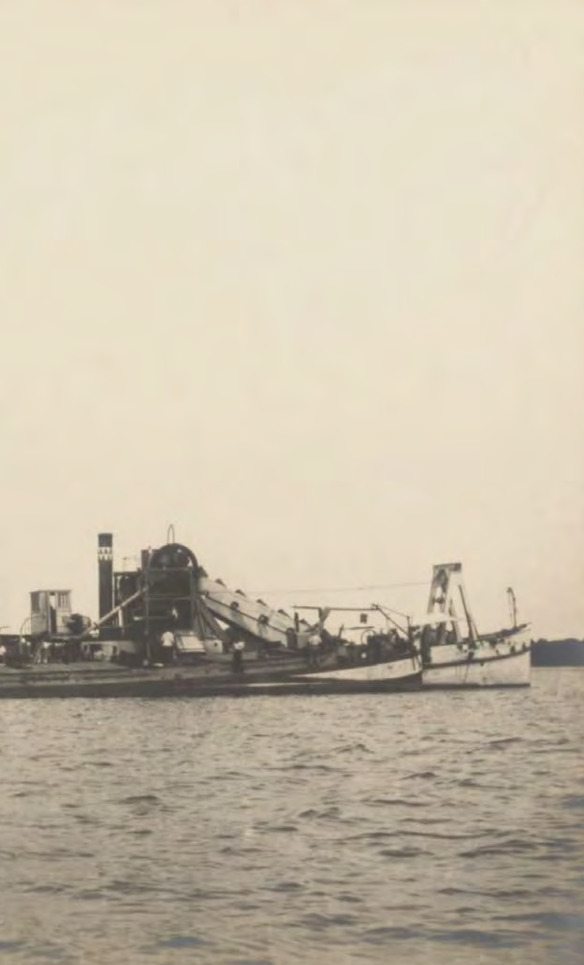
De emmerbaggermolen Patria baggert 250.000 ton grind in de rivier Uruguay, waarna het door een rijnaak over een afstand van 350km naar Rosario werd vervoerd waar het voor de bouw van de geëlektrificeerde tramlijnen door de Compañía General de Tramways Eléctricos del Rosario (CGETR) - dat met Belgisch kapitaal werkte - werd gebruikt.
